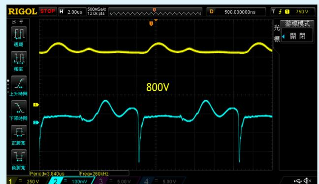
上圖為設備正常運作時，輸出800伏特且僅有微小漏電流的示意圖
