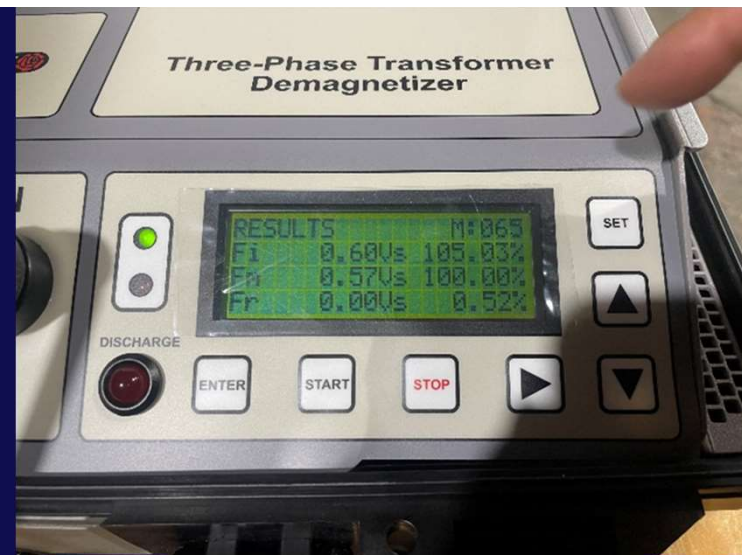
22.8KV變壓器退磁量測
