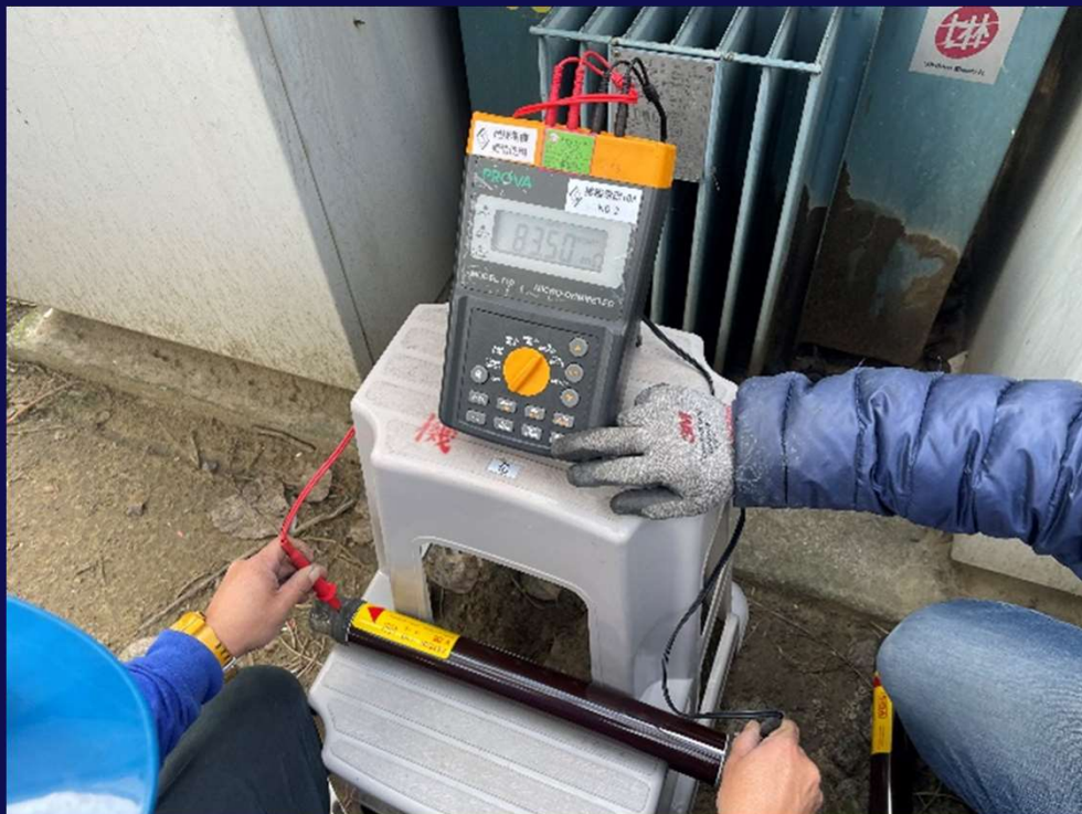
22.8KV 電力熔絲內阻量測
