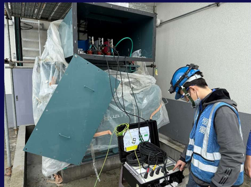
22.8KV變壓器退磁量測
