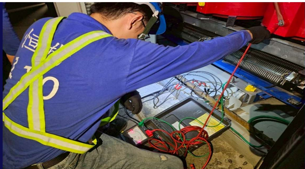
22.8KV 變壓器絕緣電阻量測
