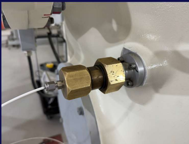
GISF6氣體取樣測試 (SO 2 ,含水量,純度,壓力)
