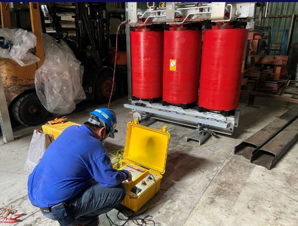
22.8KV 變壓器 電力因數量測
