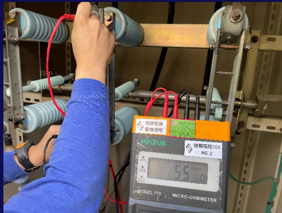
22.8KV DS接觸電阻量測
