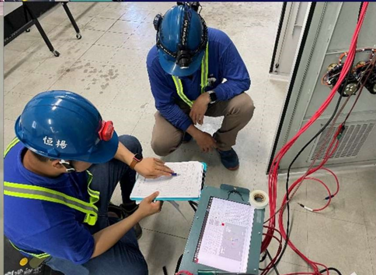
發電廠發電機保護電驛測試
