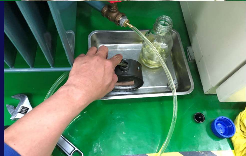
22.8KV變壓器取油送驗 (油中氣體及油品分析)
