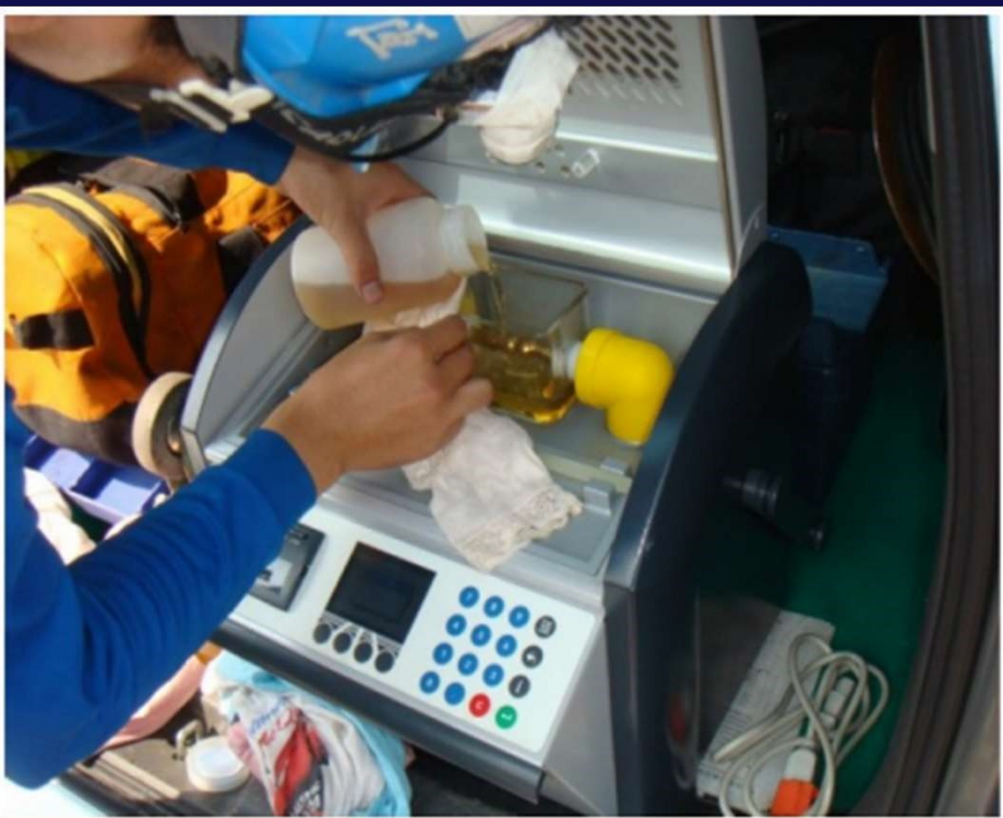
22.8KV 變壓器絕緣油量測
