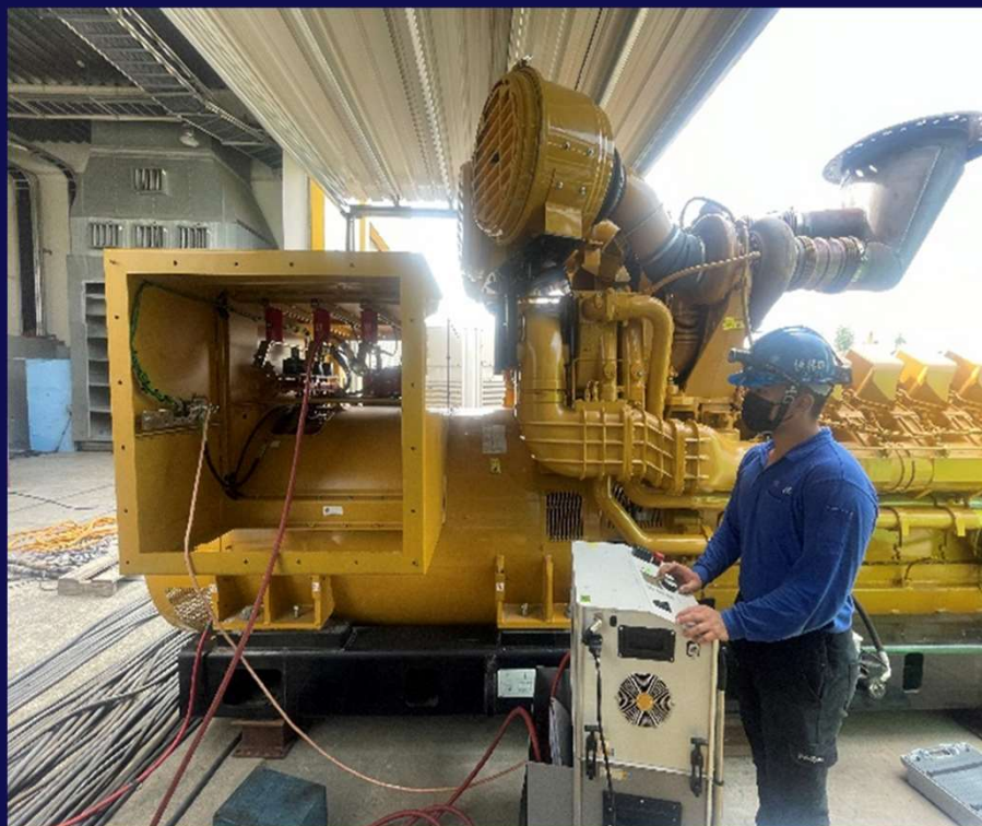
高壓發電機耐壓測試(配合廠測)
