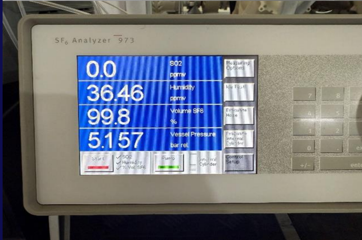
GIS SF6氣體取樣測試 (SO2,含水量,純度,壓力)
