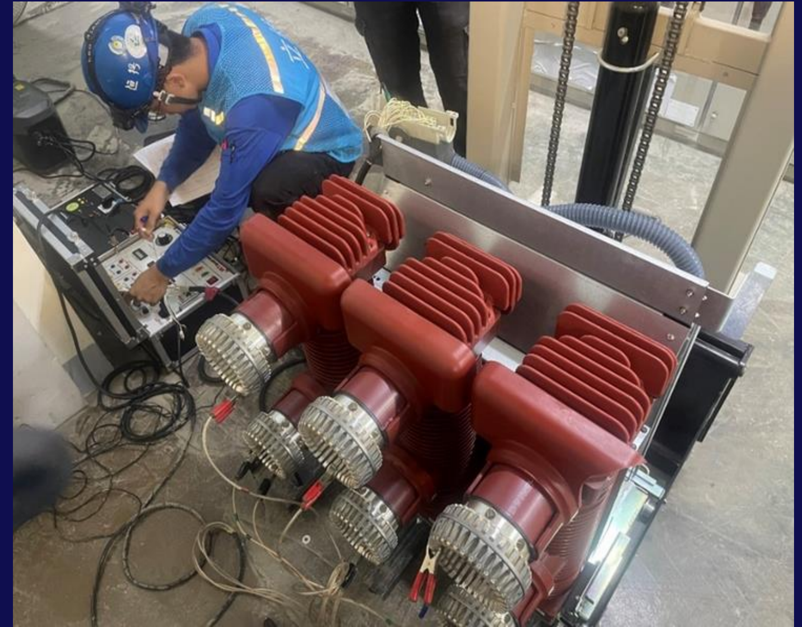
22.8kV 斷路器三相同步試驗
