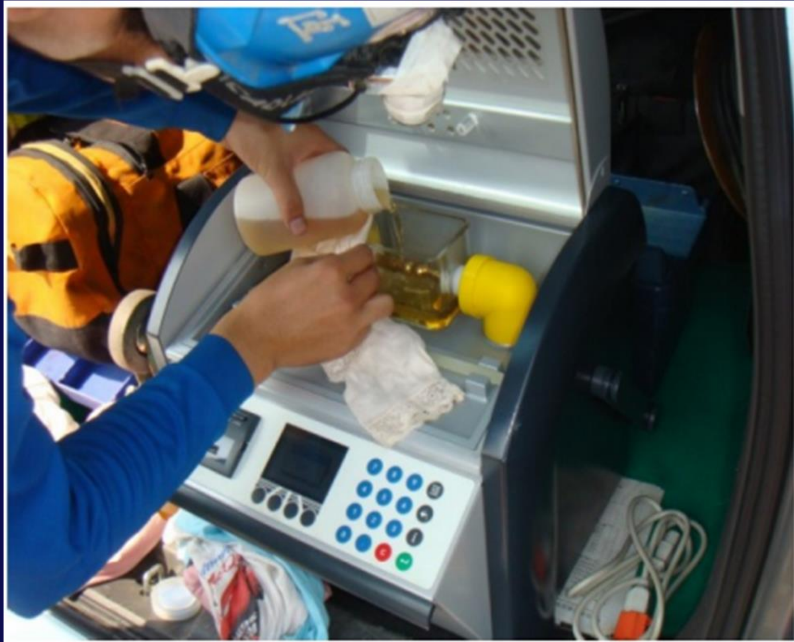
22.8kV 變壓器絕緣油耐壓量測
